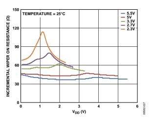
Figure 27. Incremental Wiper On Resistance vs.  $V_{\rm DD}$
